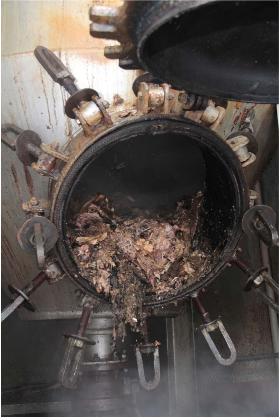
Foto 19. Digestor de corrales. Se puede observar la carne que presenta un aspecto sancochado (cocido) y los huesos blandos y prácticamente destruidos. Este material es conocido como guano.
