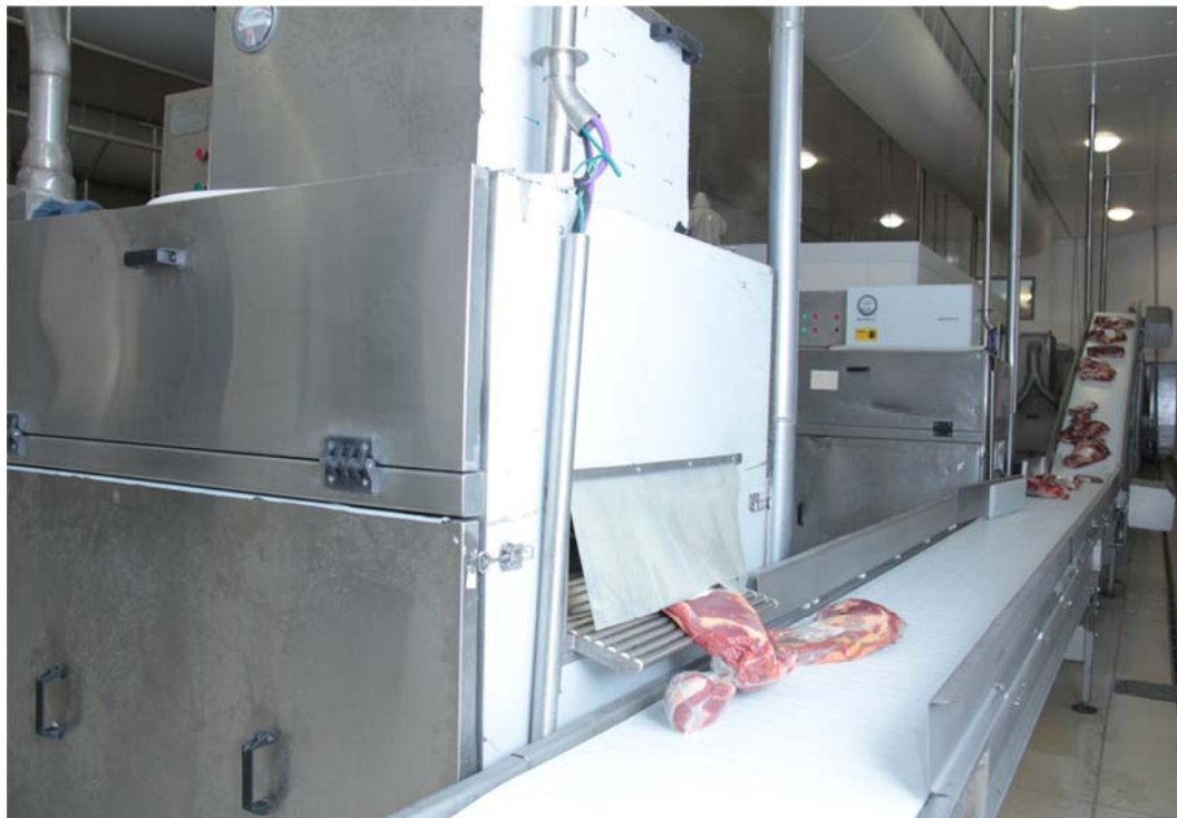
Foto 18. Cortes saliendo de la campana de termocontracción.
