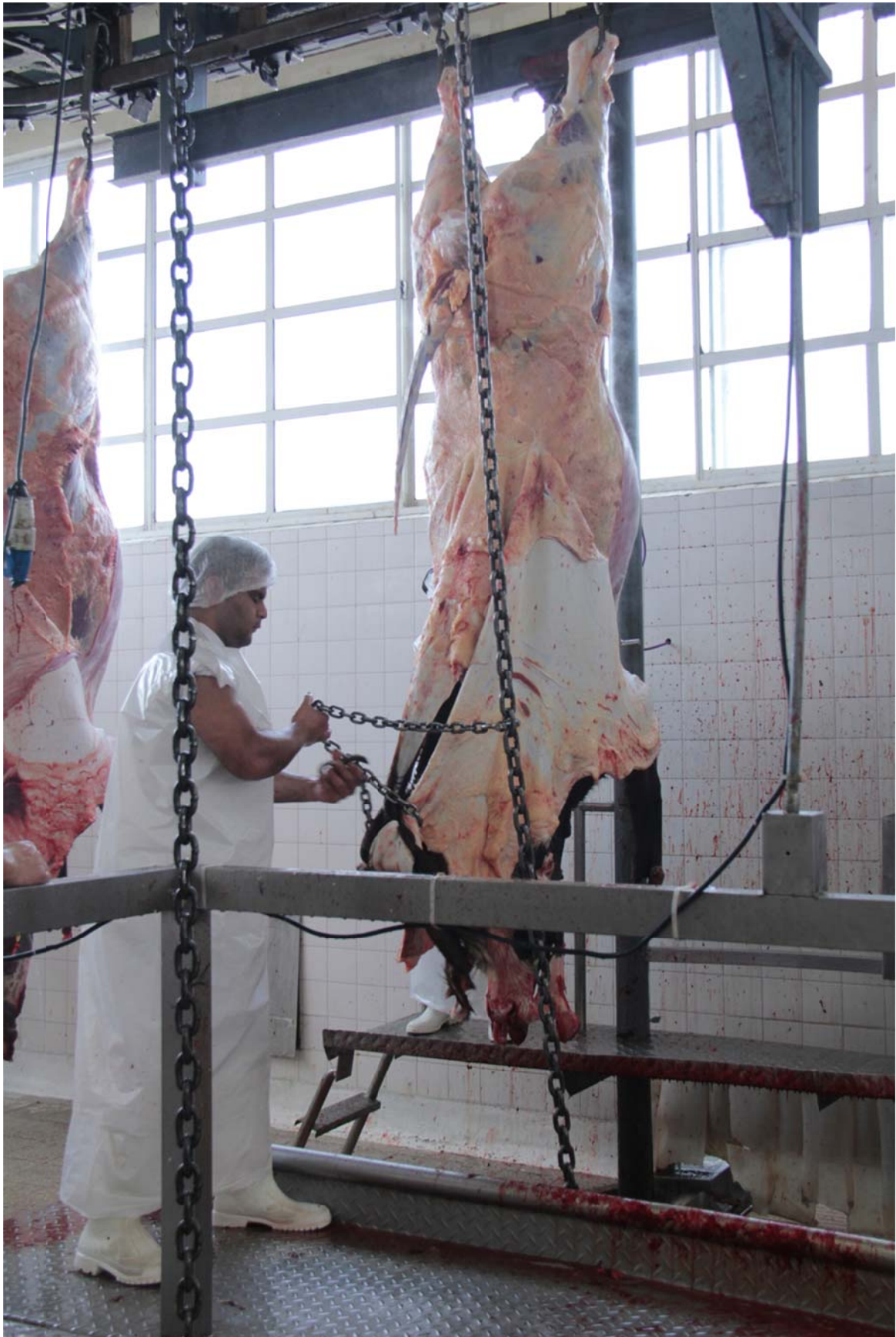
Foto 24. Down Puller o tirado del cuero desde abajo.
