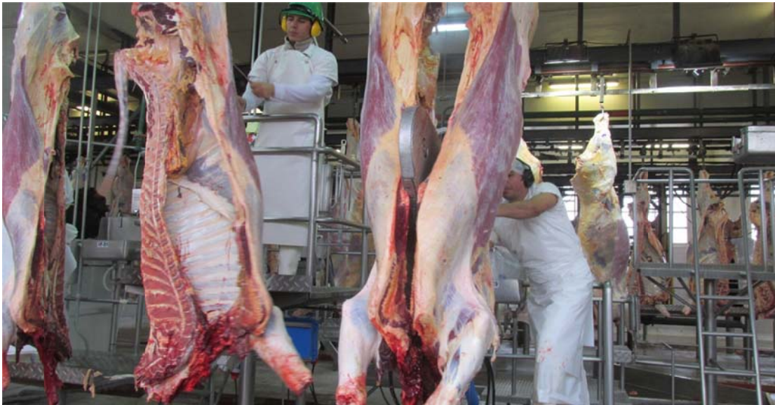
Foto 3. El palco donde se encuentra el operario es móvil, pues va bajando de acuerdo al movimiento de la noria.
