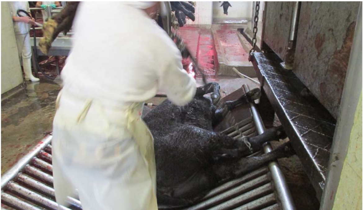
Foto 3. El bovino, después de insensibilizado, es recepcionado en la parrilla, como se observa en la foto y se le coloca la manea con la cual será izado hasta el riel de la noria.
