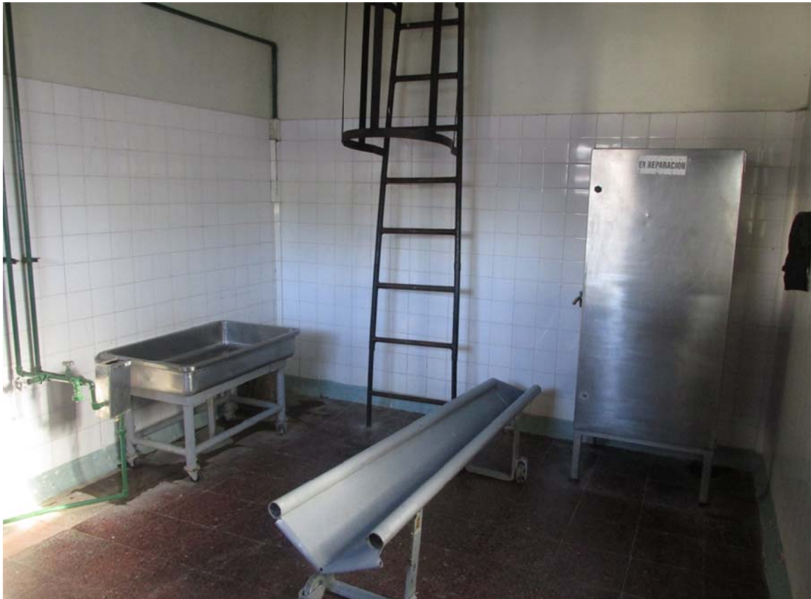
Foto 17. Sala con el catre para realizar los trabajos de necropsia. Se observa, también la bandeja en la cual se colocan los órganos a inspeccionar. La escalera conduce a la parte superior del digestor.
