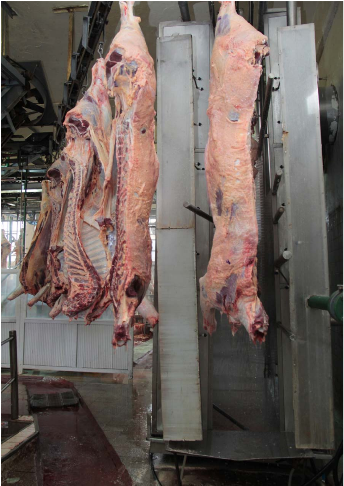
Foto 41. Se observa las medias reses entrando y saliendo al gabinete de lavado.
