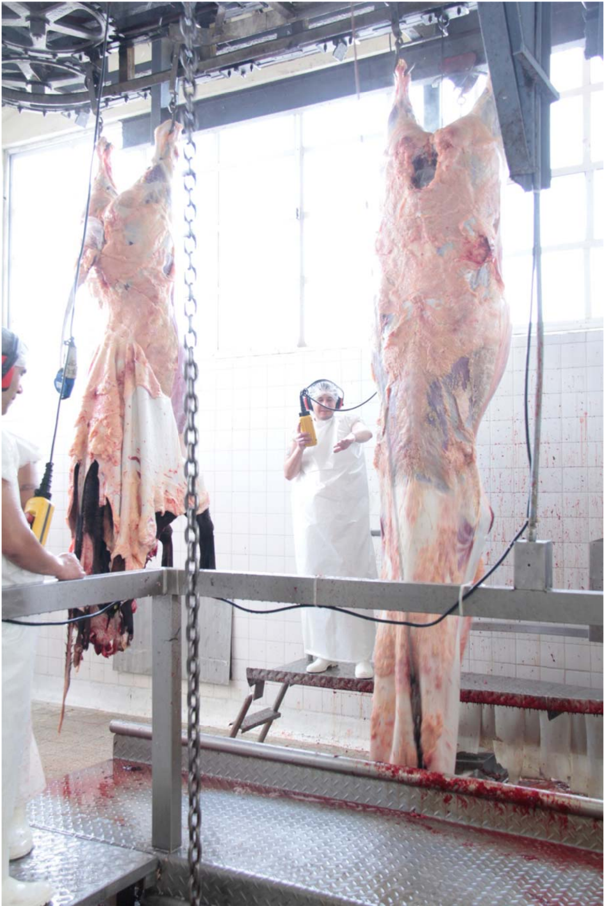
Foto 25. Down Puller o tirado del cuero desde abajo.
