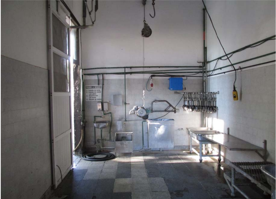
Foto 30. En esta foto se observa la sierra para cortar la res y elementos para limpieza de botas y lavamanos. En el ángulo derecho se ven las roldanas para colgar las medias reses para su revisión.
